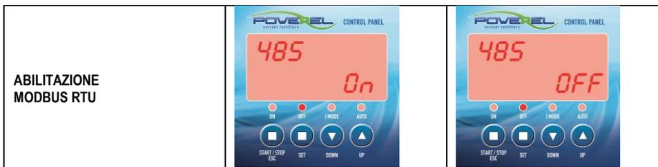
Con questa funzione si abilita il protocollo MODBUS TCP \ RTU .
