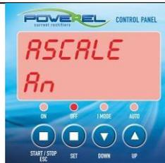
Con questa funzione è possibile scegliere la scala di visualizzazione del contatore di ampere. Il valore di default è
