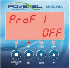
Con questa funzione si abilita il protocollo PROFIBUS \ PROFINET.
