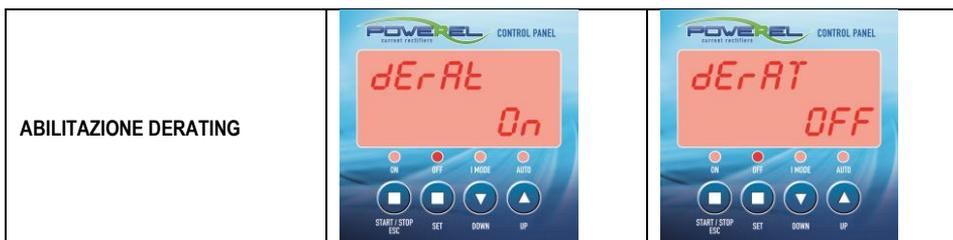
E' un modo particolare di funzionamento dove il raddrizzatore, in prossimità di condizioni estreme di lavoro con temperature prossime alla soglia di allarme, riduce automaticamente la potenza erogata a intervalli del 10% del valore impostato sino alla stabilizzazione della temperatura di funzionamento. Qualora le condizioni lo permettano è in grado di ripristinare la potenza originaria.
