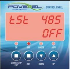
Questa funzione se attivata, controlla lo stato della comunicazione modbus durante lo stato di marcia del raddrizzatore. In caso di perdita di comunicazione, il raddrizzatore si arresta.
