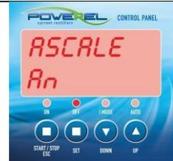
Con esta función es posible elegir la escala de visualización del contador de amperios. El valor configurado por
